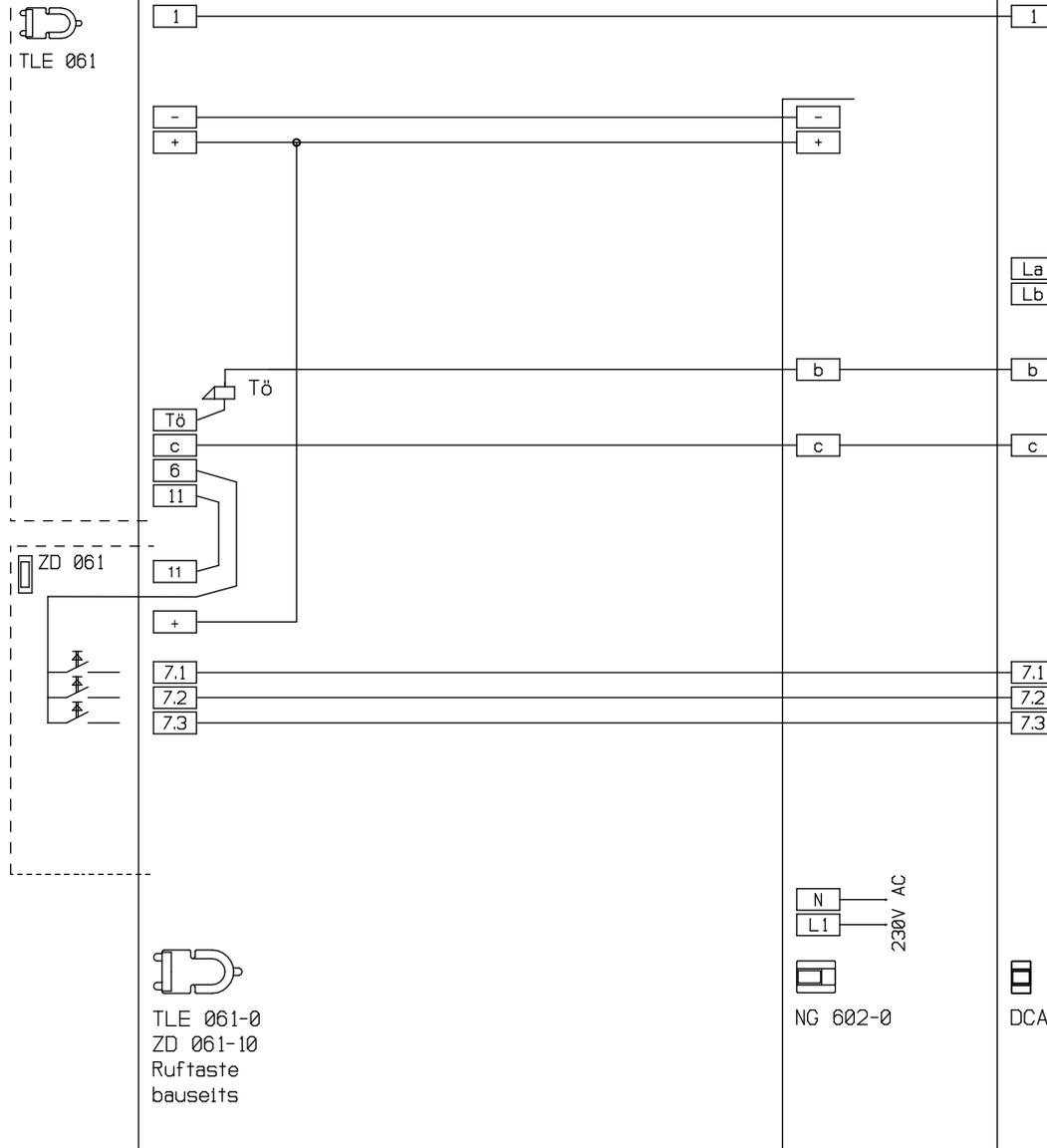
Die max. Reichweite zwischen NG 602-0 und dem DCA 612-0 darf max. 20m sein, bei 0,8mm. Zuleitung muß vom NG 602-0 direkt zum DCA 612-0 erfolgen. Bei Verwendung der Ein- und Ausgänge des DCA sind entsprechende Adern vorzusehen.
